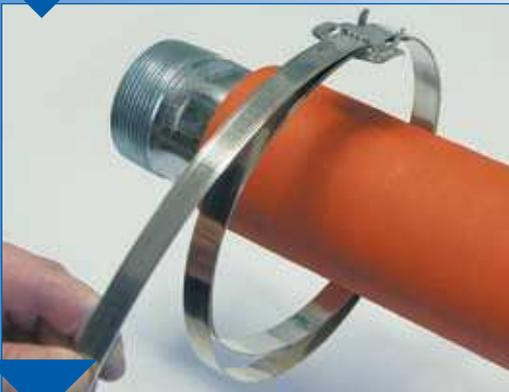
Bei hoher Belastung der Schelle, Band zweimal durch die Schlaufe ziehen.
