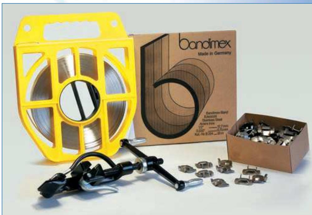
Man benötigt nur ein **Bandimex Spannwerkzeug**, **Bandimex Band** und **Bandimex Schlaufen**, um schnell und preiswert Schellen jeden Durchmessers zum Einbinden von Schläuchen aller Art, für Schilder- und Rohrmontagen sowie viele andere Verwendungszwecke herzustellen.
