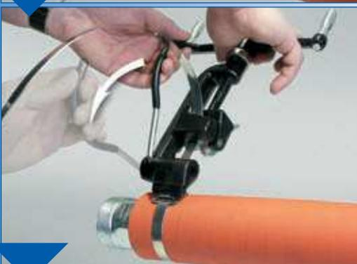
Um das Band abzuschneiden, Schneidhebel ruckartig ziehen, und das abgeschnittene Bandende mit dem Daumen andrücken.
